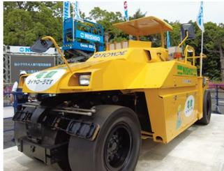
乗りものニュースに「リチウムイオンバッテリー化タイヤローラ」が掲載されました。同製品は、**まだ市場にはない電動化されたタイヤローラ**の開発により、**道路工事のGX**を目指すものです。レンタルを生業とする西尾レントオールが開発に挑戦しているという点も注目され、お取り上げいただきました。
