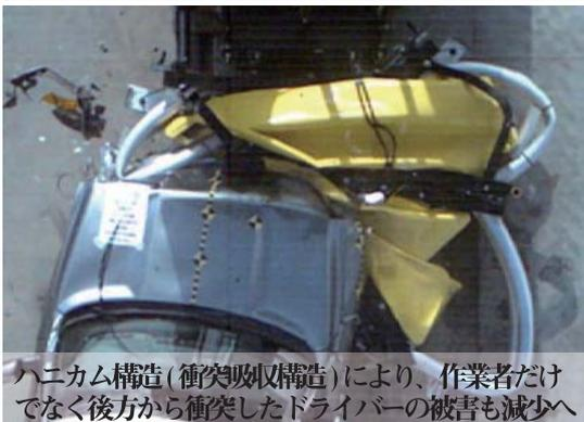
ハニカム構造(衝突吸収構造)により、作業者だけでなく後方から衝突したドライバーの被害も減少へ
