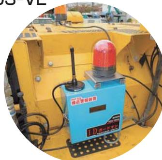
RFIDタグを携帯した作業員がIDガードマン警報装置に接近するとブザー付回転灯でオペレーターに危険を知らせます!
