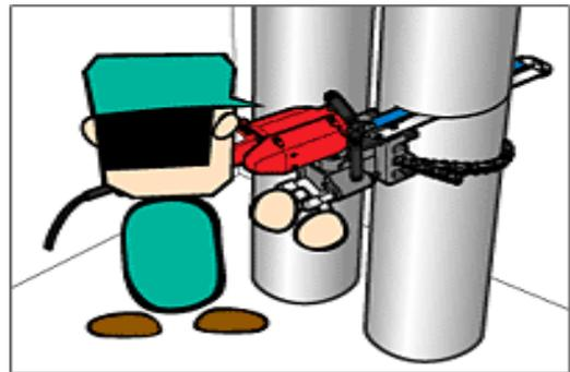
▲狭い場所で威力発揮、パイプとパイプの隙間も5cmあれば切断可。
