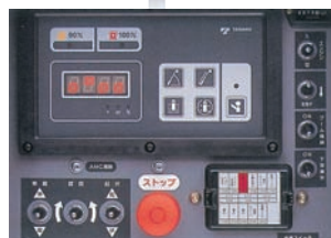
下部左側面操作部
