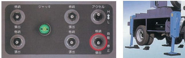
車両後端操作部
