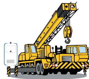
クレーンのアウトリガの傾斜監視
