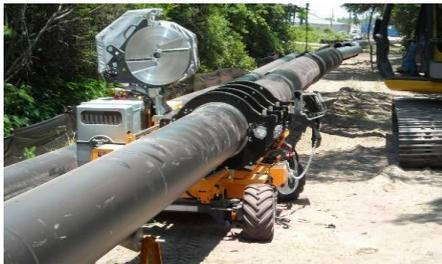
自走式 全地形対応型 ポリエチレンパイプ用バット融着機
