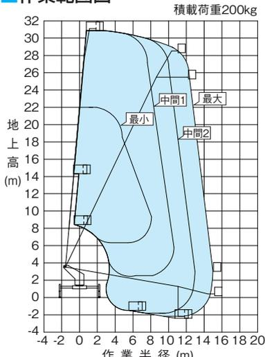
作業範囲はブームのたわみ及び干渉規制部分は考慮されていません。また、ブームが車両真横にある場合を示し、車両前後方向の作業範囲は範囲図下部の図の様になります。アウトリガの張出力及びブームの旋回角度に応じて作業範囲は変化します。
