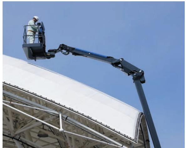
\*先端ジブ付なので障害物をかわして作業ができます。
